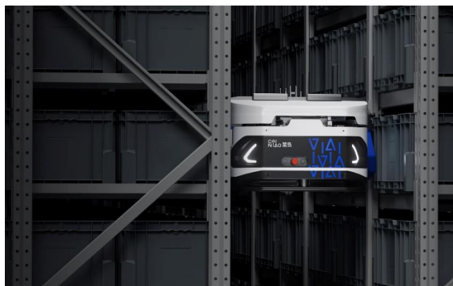
図 3： 2026 年 4 月に MODEX 2026 で発表したクライミングロボット「ZeeBot」。高さ 12m・床面積 1 m 2 あたり 48 箱の高密度保管を実現。
