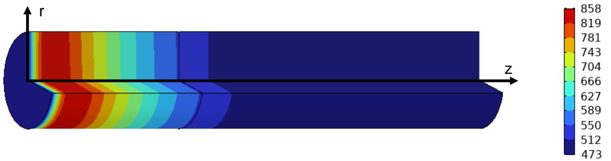
図 4 固相温度分布 [K]
