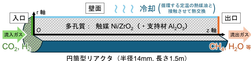
図 1 解析対象とするメタネーションリアクタのレイアウト
