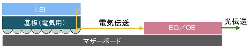
(注) 光電変換を行うために、電気回路である LSI と、電気／光変換 (EO) と光／電気変換 (OE) を行うモジュールをそれぞれ独立して設置する必要がある。EO/OE モジュールは、マザーボードの接続部に設置される。
