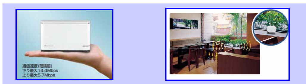
【図表 35】フェムトセル基地局イメージ(ソフトバンクモバイルの例、左:ホーム用、右:店舗用)
